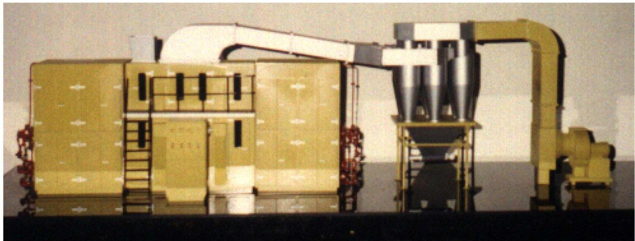
Предназначена для сушки скрученного чайного листа при производстве черного и зеленого байхового чая. Обеспечивает мягкую сушку чайного листа и высокое качество готового продукта.
